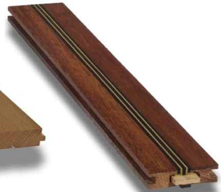
Mit drei eingeklebten Neoprenstreifen kann dieses einteilige Dehnungsprofil erhebliche Schrumpf- und Quellungsbewegungen des Holzes aufnehmen.
