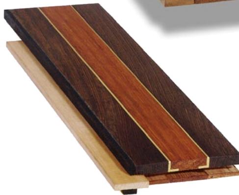
Elastilon-Dehnungsprofile lassen sich auch als gestalterische Elemente einsetzen, etwa als Zwischen- und Randfriese. Dazu sind mittig kontrastierende Hölzer eingesetzt, und das Dehnungsmaterial ist an den äußeren Längsseiten befestigt.
