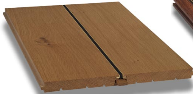
Massivdielen mit eingeklebtem Neoprenprofil. Wenn die Verlegerichtung beibehalten werden soll, ist bei einer Diele die gefräste Feder zu entfernen und eine Nut einzufräsen.
