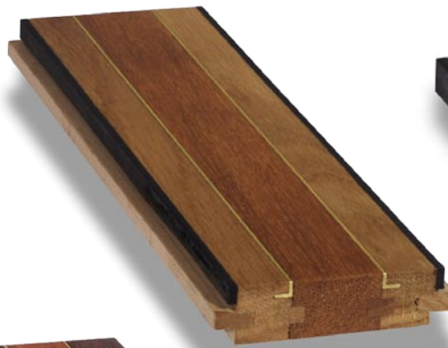
Massivdielen mit eingeklebtem Neoprenprofil. Wenn die Verlegerichtung beibehalten werden soll, ist bei einer Diele die gefräste Feder zu entfernen und eine Nut einzufräsen.
