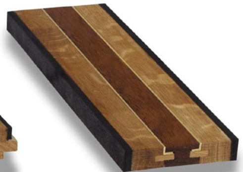
Mit drei eingeklebten Neoprenstreifen kann dieses einteilige Dehnungsprofil erhebliche Schrumpf- und Quellungsbewegungen des Holzes aufnehmen.
